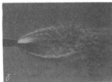
Рис. 1.2. Турбулентная недорасширенная струя, истекающая в затопленное пространство ( M_a=3 , n=16 ):
